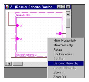
• un nouveau « Dossier schéma » portant le nom donné dans la case « Implementation » lors de la création du bloc est créé ainsi que les différents signaux d'entrée et de sortie mentionnés dans le « Bloc hiérarchique ». Ces différents signaux sont représentés par des « Ports hiérarchiques ». Ceux-ci sont disposés automatiquement sur le schéma avec les entrées à gauche et les sorties à droite (malgré le sens des flèches des ports : ils pointent obligatoirement vers le centre!).
