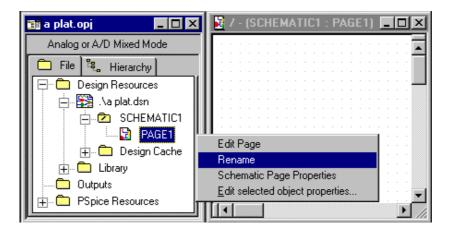
ajouter une nouvelle « Page schéma » dans le même « Dossier schéma »: sélectionner le « Dossier schéma »
