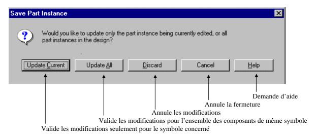
• Le nom du symbole modifié apparaît maintenant dans le « Design Cache » avec un nom sous la forme « NomComposant\_Chiffre » : ceci permet d'identifier les différentes versions d'un même composant.
