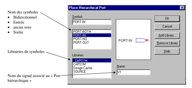
• lorsque le nouveau « Dossier schéma » est terminé, revenir sur le « Dossier schéma Racine » puis créer un « Bloc hiérarchique ». Le nom mentionné dans la case « Implementation » doit correspondre au nom du « Dossier schéma » qui va y être associé.
