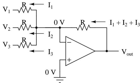
$$V_{\text{out}} = - (V_1 + V_2 + V_3)$$
