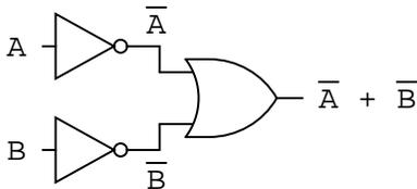
$$\overline{AB} = \overline{A} + \overline{B}$$
