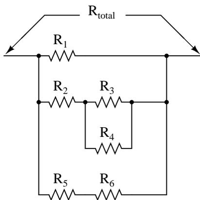
$$R_{\text{total}} = R_1 // [(R_3 // R_4) -- R_2] // (R_5 -- R_6)$$
